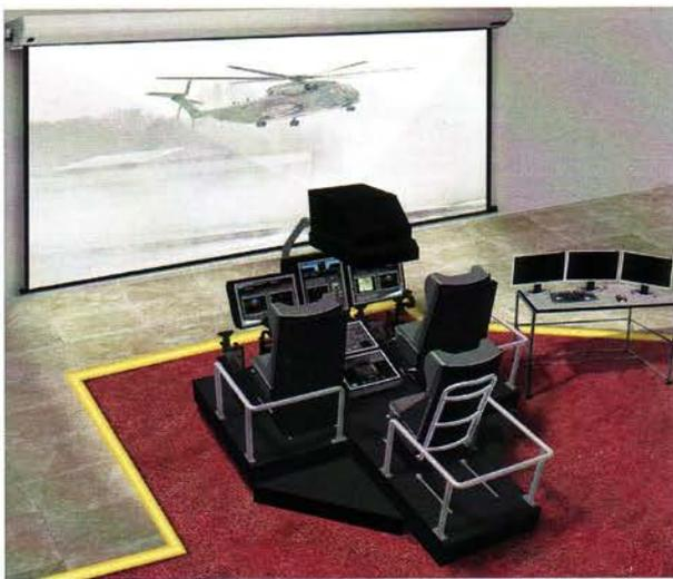
Das Aufzeichnen von Prozeduren durch den Ausbilder und die Kontrolle durch den Computer während des Durchführens einer Wartungs- oder Bedienprozedur („Computer-Guided Mode“) ermöglichen das Steuern des Lernfortschritts sowie das Erfassen des Lernerfolgs. Der Ausbilder kann die Prozedurdefinitionen mit Feedbacks oder gezielter, optionaler Hilfestellung ergänzen.
